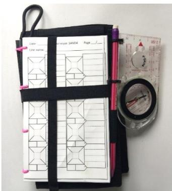
Abbildung 10: Surveynotes mit Schlaufe für Bleistift mit Kompass
